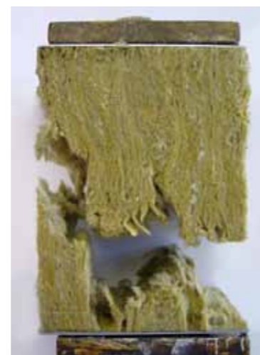
Zugfestigkeit (Materialbruch Mineralwolle)
